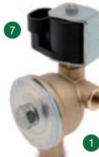
L'elettrovalvola di intercettazione del GPL liquido è un dispositivo posizionato tra serbatoio e riduttore che interrompe il flusso del GPL durante il funzionamento a benzina ed a motore spento. Compatta e di minimo ingombro, disponibile in versione normale e maggiorata, dotata di filtro intercambiabile. La sostituzione e/o pulizia filtri avviene senza scollegare i tubi di alimentazione.
