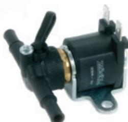
Dispositivo posizionato fra il tubo proveniente dalla pompa benzina ed il carburatore che interrompe il flusso della benzina durante il funzionamento a gas. È dotata di rubinetto d'apertura manuale in caso di avaria del dispositivo elettrico. Tutti i dispositivi sono omologati secondo le normative europee 10R-02 (Compatibilità Elettromagnetica) 67R-01, 110R-00, ISO15500.
