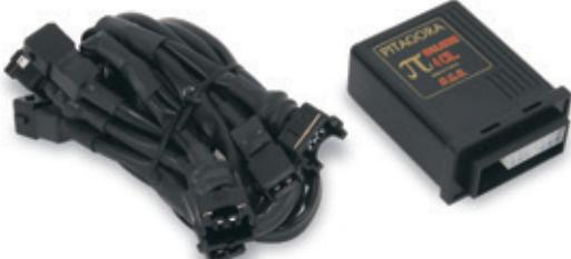
Gli emulatori sono dispositivi elettronici atti alla simulazione di alcuni segnali originali della vettura, che devono essere interrotti o modificati durante il funzionamento a gas (iniettori benzina, sonda Lambda, MAP, ecc.). Mediante il loro utilizzo si evita che la centralina originale della vettura rilevi false anomalie dovute al fatto che il motore non sta funzionando a benzina e di conseguenza si esclude l'accensione ingiustificata della spia "avaria motore" (check engine).
