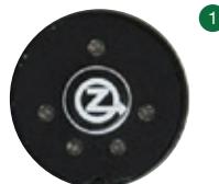
Si tratta di un commutatore a pulsante One-Touch ad una posizione, con avvisatore acustico (Buzzer) integrato. Inoltre indica il livello gas tramite da 4 led verdi che possono anche indicare eventuali segnali di errore ed un led bicolore (verde/rosso) per segnalare il funzionamento a gas o a benzina.
