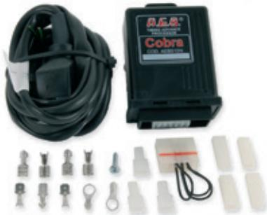
Dispositivi che modificano l'antincipo originario della vettura durante il funzionamento a gas e ripristinano l'antincipo originario ogni volta che si commuta a benzina. Questo dispositivo è utilizzato principalmente negli impianti Metano, essendo il Metano un carburante con un maggior numero di ottani rispetto alla benzina. L'uso del variatore migliora le prestazioni del motore. Tali dispositivi sono in continuo aggiornamento essendo inseriti nel sistema d'accensione originale della vettura.
